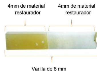
Figura 2. Medidas Cuerpos de pruebas para cada muestra.
